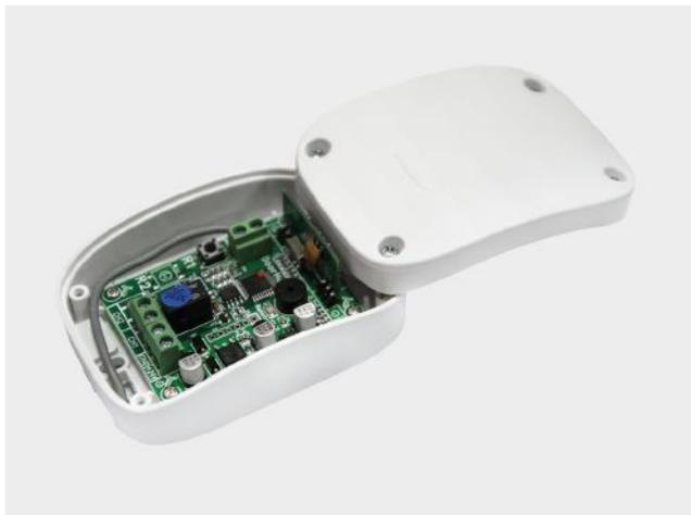
Внешний радиоприемник DHRE-1 предназначен для управления автоматикой других производителей с помощью пульта DoorHan
