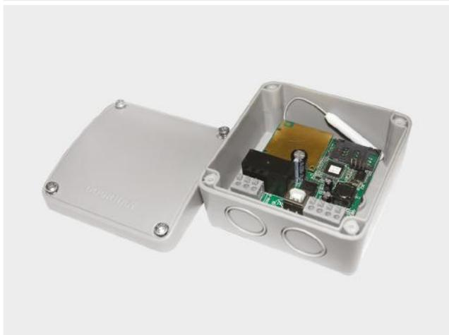
GSM-модуль предназначен для приема сигнала с мобильного телефона и передачи управляющей команды для запуска электропривода или шлагбаума
